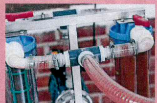
Vor dem Erhitzen wird der Saft erst einmal gefiltert.
