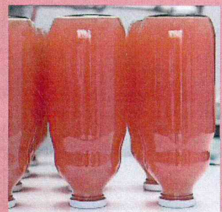
Nachdem der Saft etwa 25 Minuten lang erhitzt wurde, wird er in Flaschen gefüllt. Und kopfüber geht es dann zur Kühlung in den Hof.
