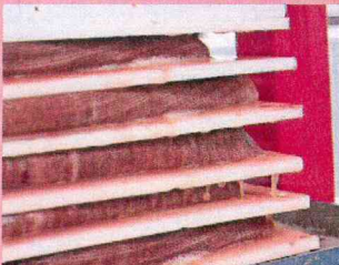
In der Packpresse wird das Obst dann ausgepresst.
