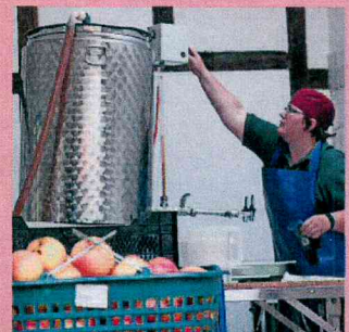
Der Süßmost wird im Kessel auf 79 Grad erhitzt und pasteurisiert.
